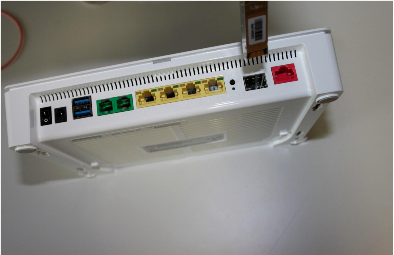
Aseta kuitukytkentäsovitin SFP-liitäntäaukkoon sovittimen lukitusvipu alapuolella
