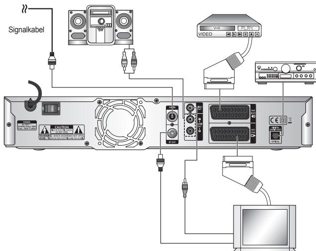
Om bildkvaliteten är dålig när kopieringsskyddade VOD (Video-on-Demand) -filmer spelas, anslut mediaboxen direkt till TV:n. Koppla inte in via en videobandspelare.
